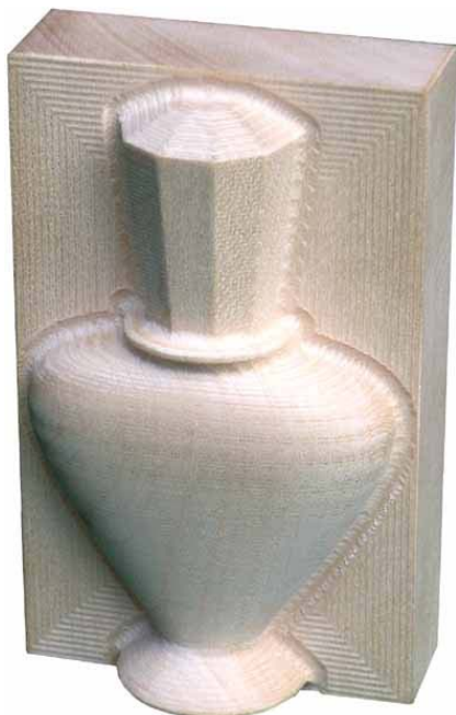
Parfumflasche mit Portalanlage gefräst
