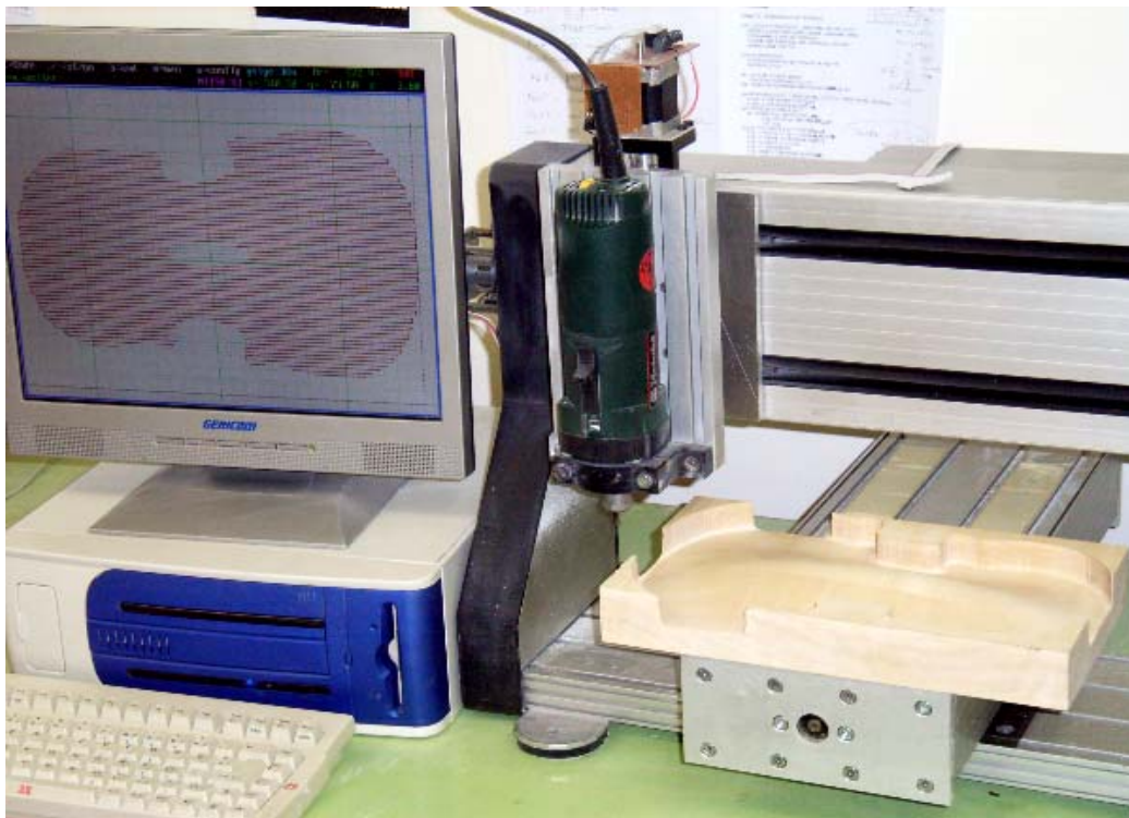
Mit MOVIX 3-dimensional gefräster Geigenboden mit Echtzeitvisualisierung (Oberseite)
