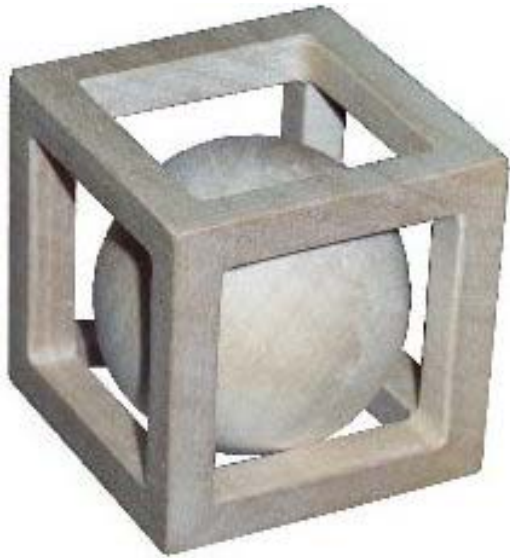
3-dimensionale Kugel im Käfig aus dem Vollen gefräst
