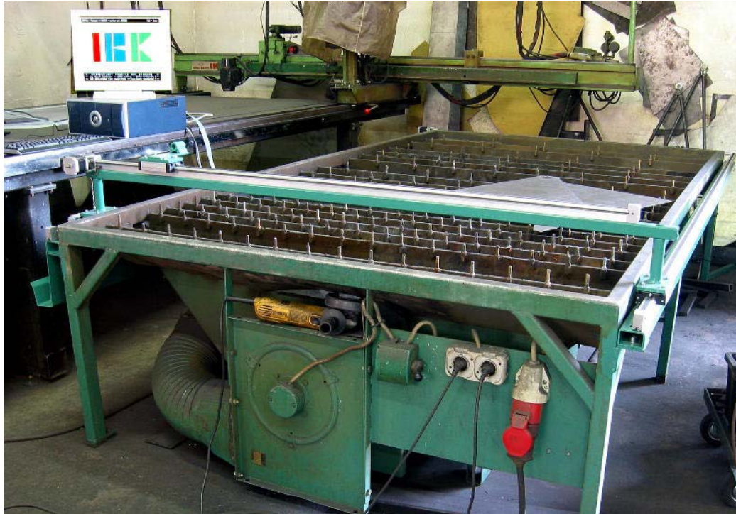
Aufrüstung einer Plasma- Schneideanlage mit einer MOVIX - 2D-Positioniersteuerung mit Zahnriemenantrieb
