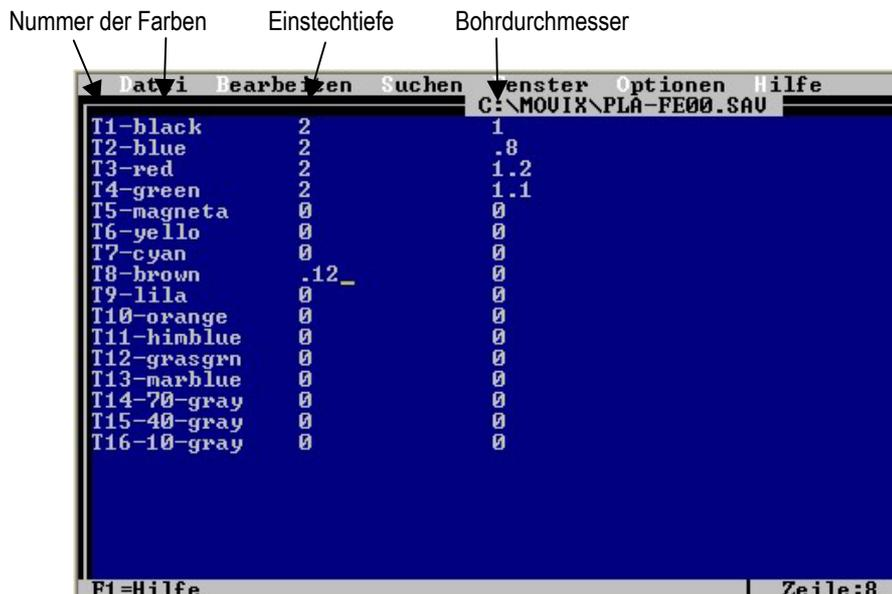
Bild 5: Die Farb-Konfigurations-Datei für Einstechtiefen und Bohrdurchmesser (PLA-FE00.SAV)
