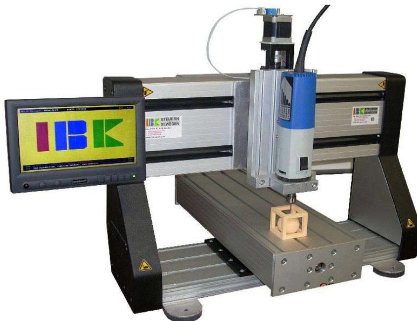
Das Arbeitsferd - PT360 \* CAD/CAM-System für "Rapid Prototyping"
